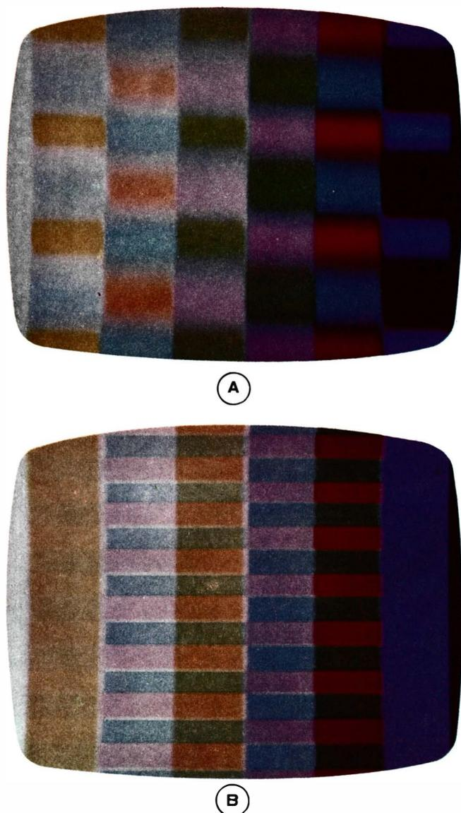
Fig. 7-15. Efeito causado na tela pelo oscilador 3,58 MHz não sincronizado (A) e sincronizado (B) (observe a primeira e a última barra colorida — amarela e azul).
