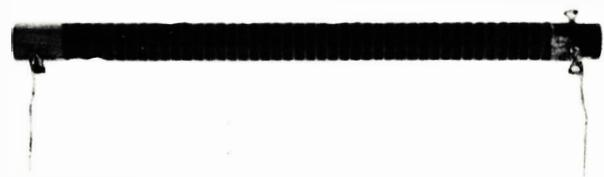
Fig. 4-14. Linha de atraso de luminância.
