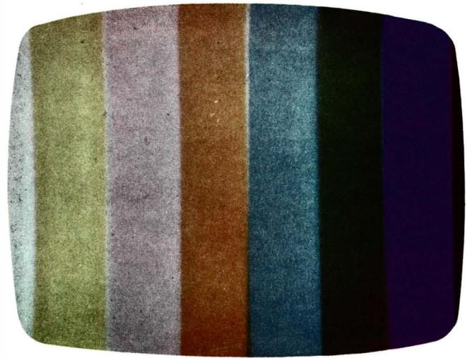
Fig. 7-17. Oscilador 7,9 KHz com a frequência correta reproduzindo as barras turquesa-magenta e verde-vermelho em sequência inversa (observe que estas côres foram alteradas devido aos níveis de luminância).
