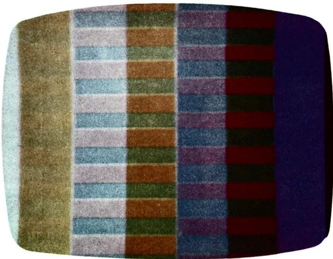
Fig. 7-16. Oscilador 7,9 KHz sintonizado incorretamente.
