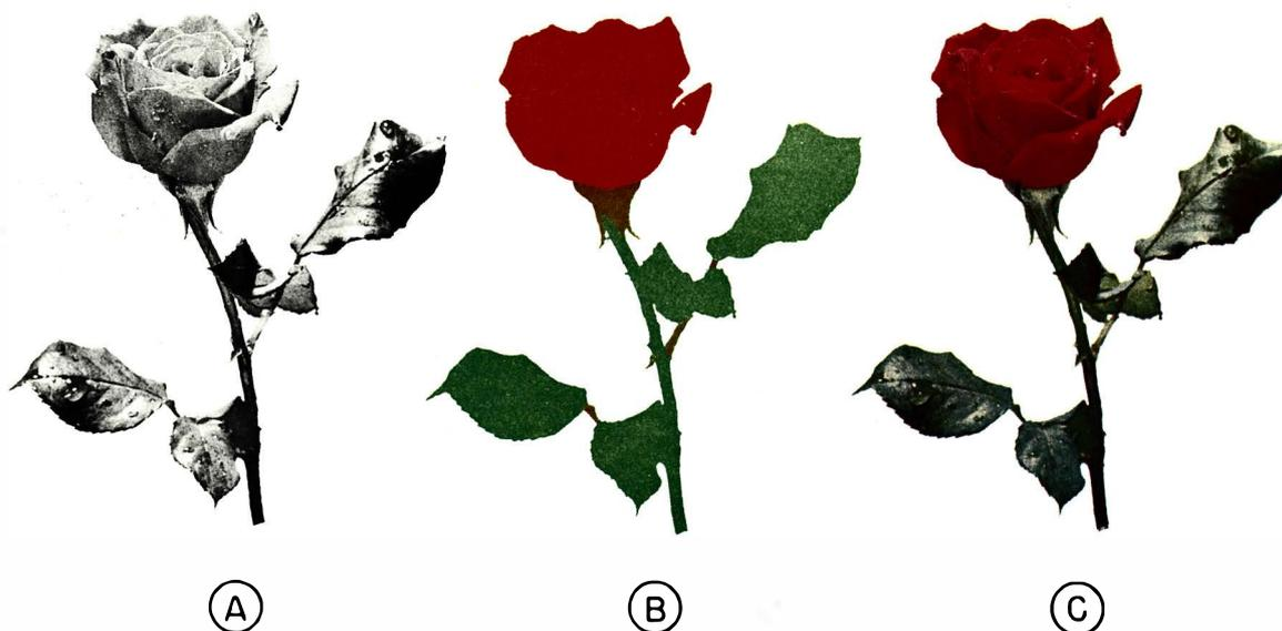
Fig. 3-9. Componentes de luminância (A) e crominância (B) de uma imagem colorida (C).
