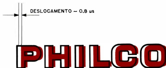
Fig. 4-12. Deslocamento entre os sinais de luminância e crominância.
