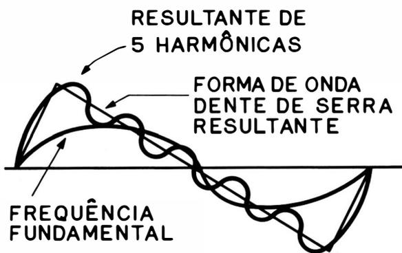
Fig. 3-50. Derivação de uma onda dente de serra.
