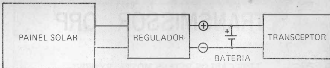
FIG. 3 — Diagrama de ligações do sistema de energia solar para Radioamadores.
