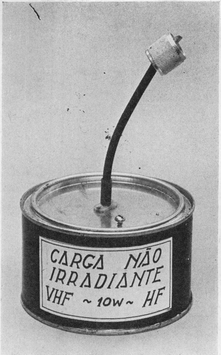
FOTO II — Vista da montagem terminada da carga não-irradiante para VHF.
