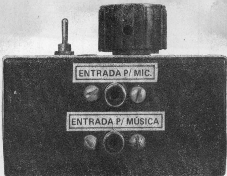
FOTO I — Em uma das faces laterais da caixa foram aparafusados os jaques para microfone (J1) e para música (J2).
