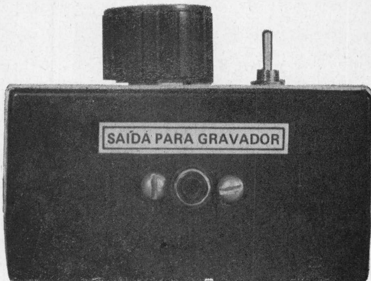
FOTO II — Na face oposta à mostrada na Foto I, fixamos o jaque de saída para o gravador (J3).
