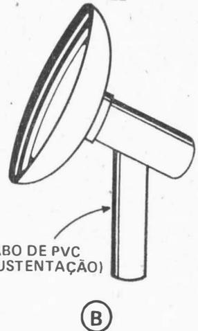
FIG. 8 — a) O microfone introduzido no tubo de PVC é envolvido por espuma de borracha; b) vista da montagem terminada, mostrando o cabo para segurar o microfone, também feito de PVC.
