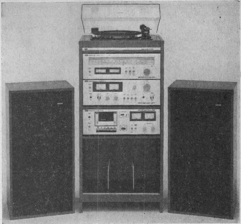
entre canais, D.H.T. de 0,16%, 2  $\mu$ V de sensibilidade em FM e 76 dB de relação sinal/ruído. O amplificador é o SA-130 com saída em Darlington de potência, D.H.T. máx. de 0,4%, potência de saída de ? W RMS/ ? chms/1 ou 2 canais? 80 W IHF (argh!!!) especificados sem maiores detalhes. Resposta de frequência de 36 Hz a 42 kHz/—3 dB e
