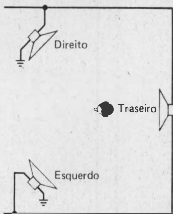
FIG. 1 — Idéia básica do Sistema Hafler de acrescentar um único falante traseiro.
