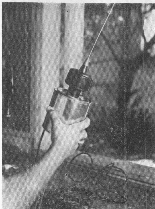
FOTO 3 — Tampe a lata firmemente, apoiando-a na beira da bancada, e rosqueie a bobina no lugar.
