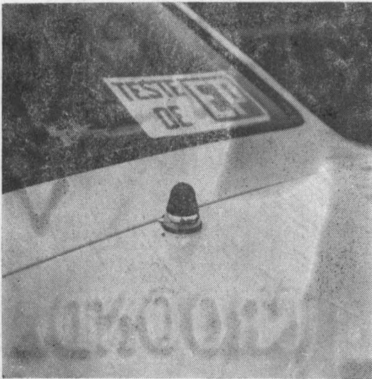
FOTO 4 — A tampa que acompanha o "kit" dá proteção contra poeira e umidade aos contatos da base.
