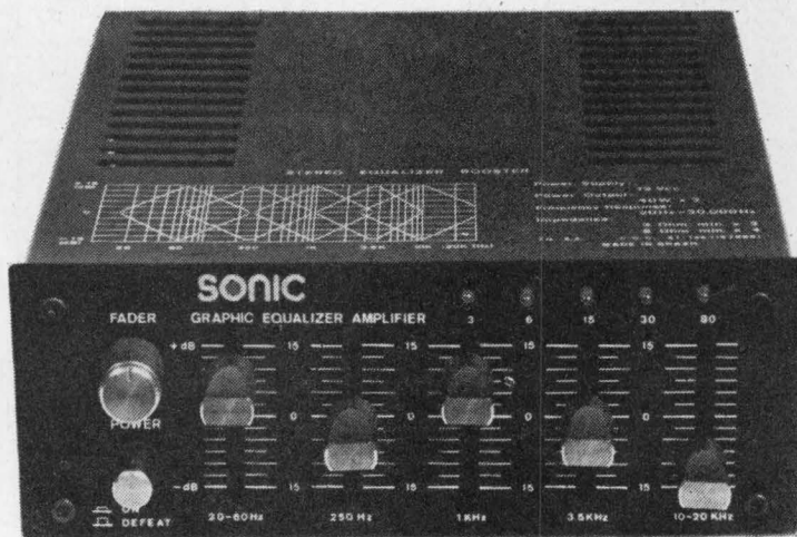
FOTO 2 — Pannel frontal do Sonic BQ-B1, vendo-se, na parte superior, a impressão em destaque (tinta branca) de algumas das características técnicas mais importantes.
