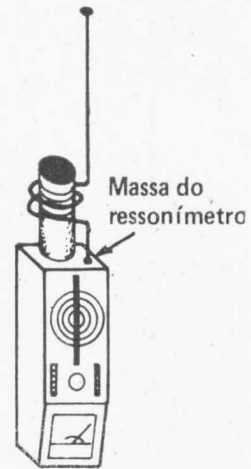
FIG. 7 — Procedimento para se medir intensidade de campo com o ressonímetro.
