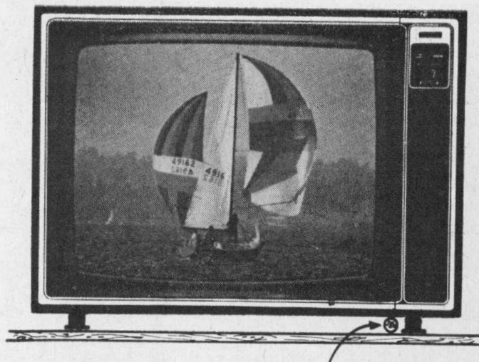
Fotorresistor colocado sob o gabinete do televisor, junto a um dos pés, afastado da parte frontal em, aproximadamente, 10 cm
