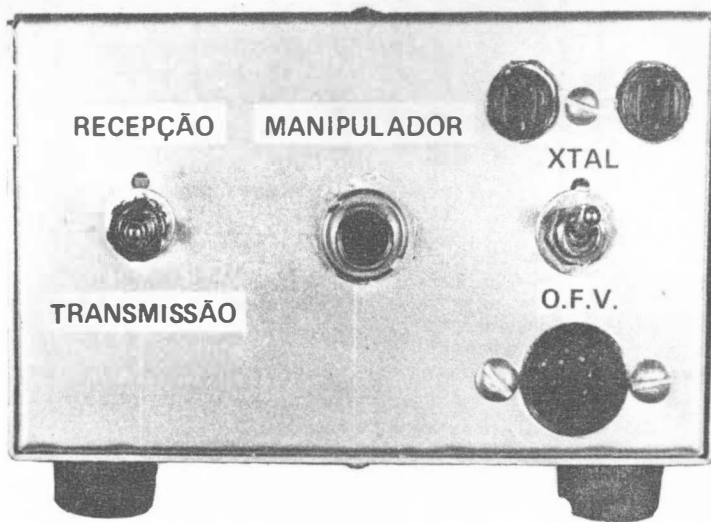
Foto 6 — Painel frontal do módulo excitador/amplificador de potência. Para uso de cristal oscilador, este será encaixado nos receptáculos acima da chave comutadora XTAL/O.F.V.
