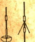
Antena Vertical multibanda para 10, 15 e 20 metros. Com bobina de corte frequência blindada, tipo auto suportada. R.O.E. abaixo de 1,5/1.
