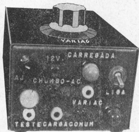
FOTO II — Aspecto do painel frontal do Rejuvenescador de Pilhas/Carregador de Baterias.
