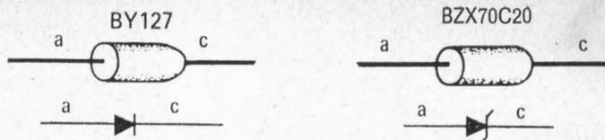
FIG. 2 — Identificação dos terminais dos semicondutores empregados na montagem da fonte.
