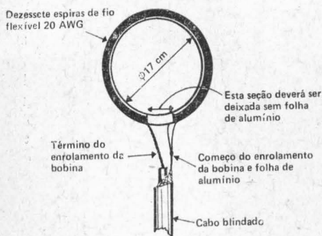
FIG. 5 — Detalhes construtivos da bobina exploradora L1.
