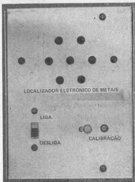
FOTO III — Aspecto do painel frontal do localizador de metais. Os orifícios destinam-se à passagem do som produzido pelo alto-falante.
