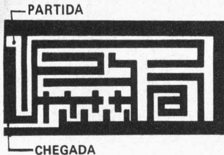
FIG. 7 — Duas sugestões para a confecção do "labirinto". É utilizada uma plaqueta de fenolita cobreada. Portanto, a parte escura é a que deve ser coberta com esmalte, ou qualquer outro protetor, na hora do banho de perclorato de ferro.
