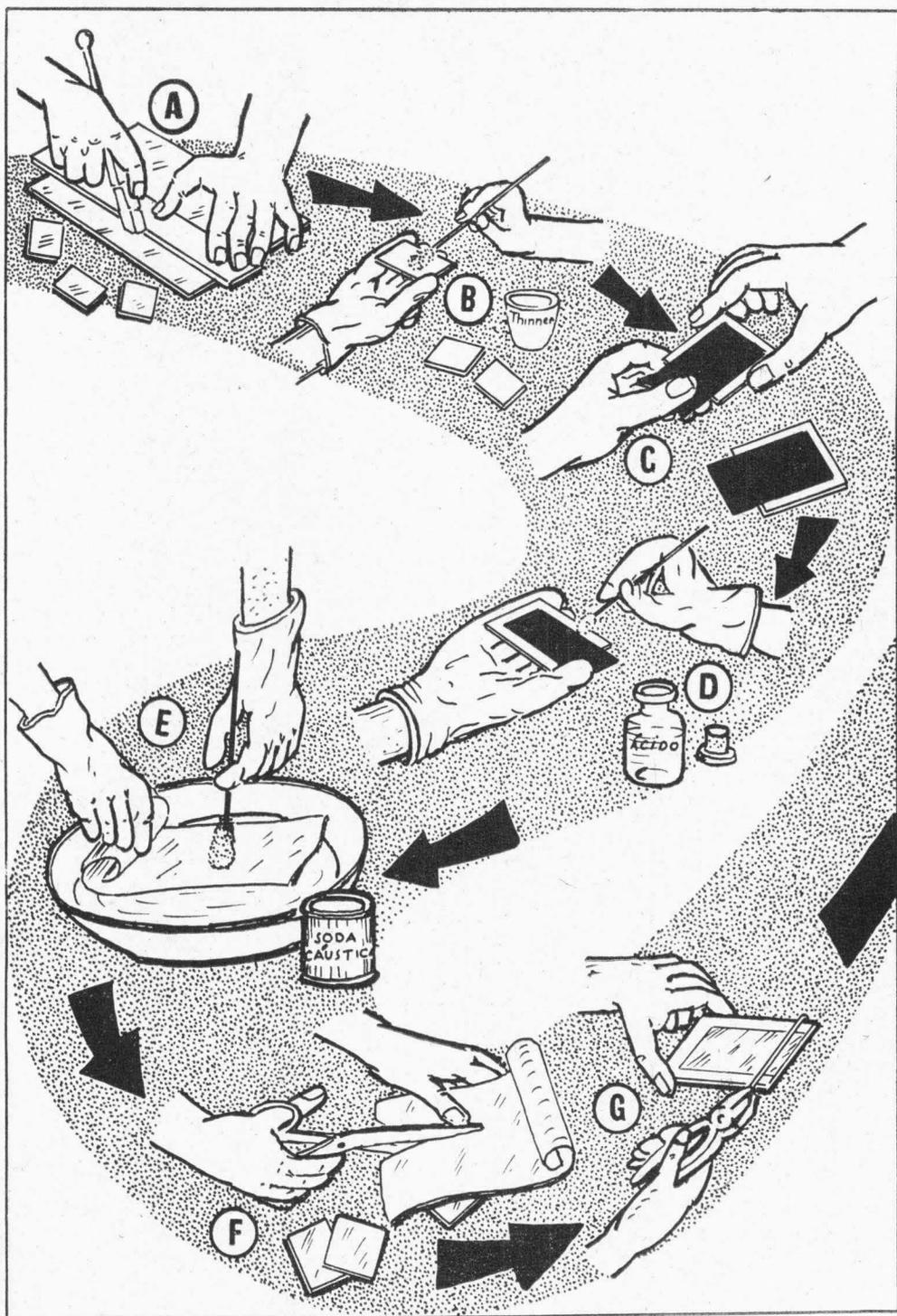
FIG. 6 — Sequência de procedimentos para a construção de capacitores de vidro/prata. (A)
