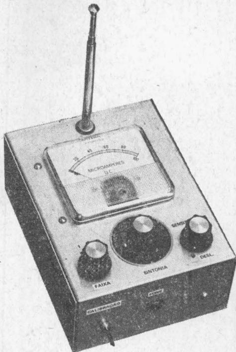
A sensibilidade do aparelho, ou seja, a tensão de radiofrequência retificada que atua sobre o medidor, pode ser controlada por um potenciômetro, permitindo, assim, a verificação de uma grande faixa de níveis de intensidades de campo.
