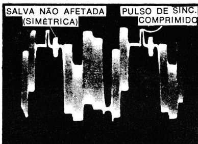
Pulso de sincronismo comprimido antes da compressão do sinal de crominância.
