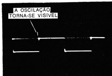
Onda quadrada de 10 kHz. A oscilação de alta frequência pode ser vista nos cantos anterior e posterior.
