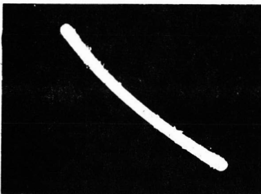
Ausência de desvio de fase, mas a não linearidade de amplitude é demonstrada pela curvatura da diagonal.
