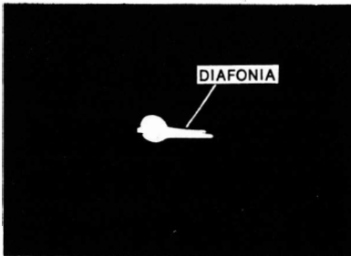
Diafonia entre o oscilador dente-de-serra e o amplificador horizontal.
