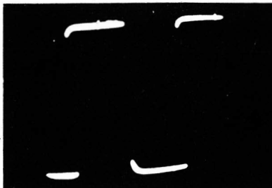
Arredondamento dos cantos da onda quadrada, com o controle de contraste ajustado para o mínimo.
