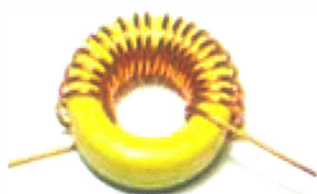
FIGURA 08 -Bobina L1 = 24Volts (T50-6).
