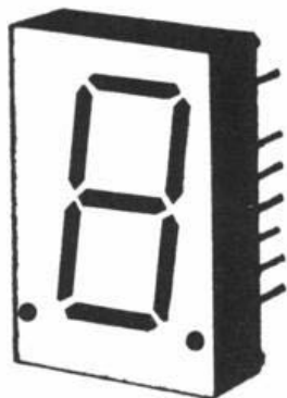
Display numérico de segmentos com LEDs.
