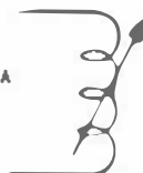
SÍMBOLO DE UMA BOBINA CUJA INDUTÂNCIA É VARIÁVEL.
